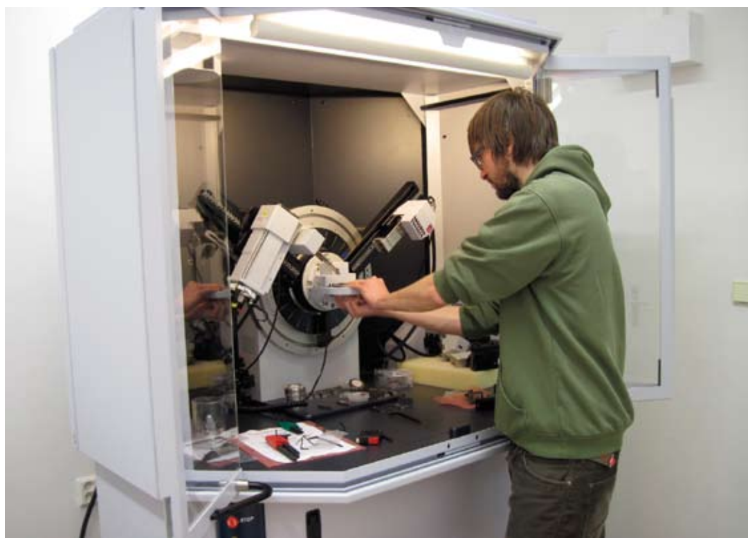
Univerzální rentgenový práškový difraktometr Bruker D8 Advance pořízený pro laboratoře PM v Horních Počernicích
